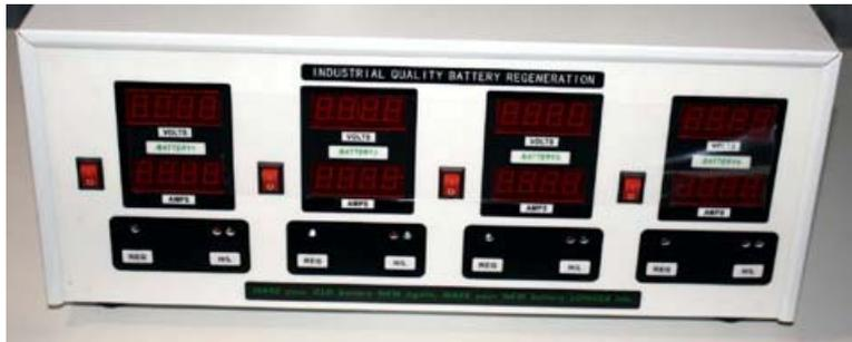
REGBAT Pro adopte la technologie de régénération par impulsions électrique, afin de revitaliser les batteries 12v "fatiguées". L'impulsion électrique est envoyée à la fréquence de résonance du sulfate de plomb, va le faire vibrer et le faire tomber en fines particules, et ensuite, le sulfate va se dissoudre dans l'acide.
